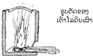
ເຕົາໂລ່ດິນເຜົາທີ່ມີ ຫົວເຜົາສອງຫົວ ແລະ ມີປ່ອງລະບາຍຄວັນຮູບຕັດຂອງເຕົາໂລ່ດິນເຜົາ
